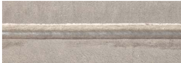
Verzinkter Stahl, 0,7 mm Kehlnaht am Überlappstoß, mit 1,0 mm Zink-Draht
