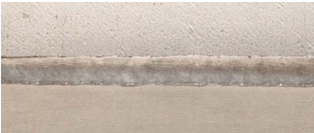
Bild 10 Al-St-Mischverbindung, 0,7 mm feuerverzinkter Stahl und 1,0 mm AlMg, Kehlnaht am Überlappstoß, mit 1,0 mm Zn-Draht coldArc -gelötet mit 0,35 m/min, U=13,5 V, I=40 A
