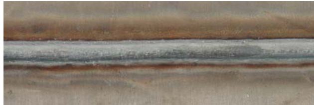
Stahlblech, 1,0 mm Stumpfstoß, 1 mm Spalt, 1,0 mm G4Si1-Draht
