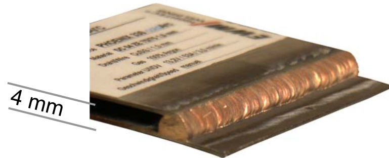
Manuelle EWM-coldArc ® -Lötung, 4,0 mm Spalt Grundwerkstoff DC 04 ZE 75/75 1,0 mm Zusatzwerkstoff CuSi3-Draht Ø 1,0 mm
