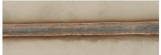
Bild 14 CrNi-Blech, 0,5 mm, Kehlnaht am Überlappstoß, 0,8 mm Draht, coldArc -geschweißt mit 2,0 m/min, U=16,5 V, I=90 A
