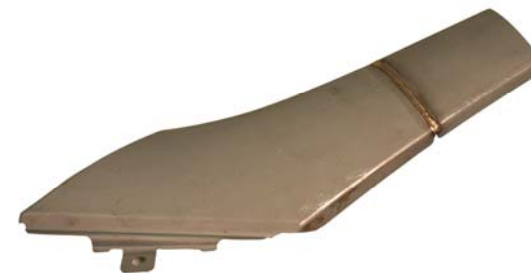
Roboter- EWM-coldArc ® -Lötung, Grundwerkstoff 1,0 mm elektrolytisch verzinktes Stahlblech Zusatzwerkstoff CuSi3-Draht Ø 1,0 mm
