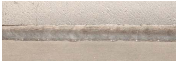
Al-St-Mischverbindung, 0,7 mm verzinkter Stahl und 1,0 mm AlMg Kehlnaht am Überlappstoß, mit 1,0 mm Zink-Draht
