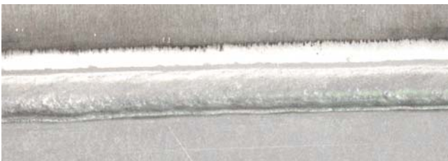
Bild 11 Al-St-Mischverbindung, 1,0 mm AlMg und 0,7 mm feuerverzinkter Stahl, Kehlnaht am Überlappstoß, mit 1,0 mm AlSi5-Draht coldArc -gelötet mit 1,1 m/min, U=14,5 V, I=60 A
