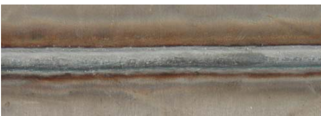
Bild 12 Stahlblech, 1,0 mm, Stumpfstoß, 1 mm Spalt, 1,0 mm G4Si1 Draht, coldArc -geschweißt mit 2,0 m/min, U=19 V, I=136 A
