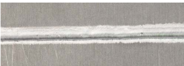
Bild 13. AlMg3-Blech, 0,8 mm, Kehlnaht am Überlappstoß, 1,0 mm AlSi5-Draht, coldArc -geschweißt mit 1,2 m/min, U=13 V, I=55 A
