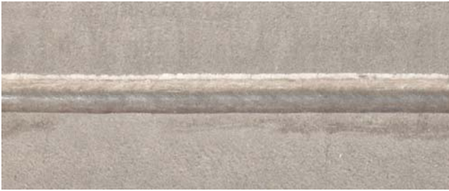
Bild 9 Feuerverzinkte Stahlbleche, 0,7 mm, Kehlnaht am Überlappstoß, mit 1,0 mm Zn-Draht coldArc -gelötet mit 0,35 m/min, U=13,5 V, I=40 A
