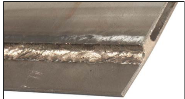
Bild 5 manuelle coldArc -Lötung von 0,8 mm elektrolytisch verzinktem Stahlblech mit 4,0 mm Luftspalt, 1,0 mm CuSi3-Draht
