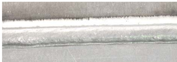
Al-St-Mischverbindung, 1,0 mm AlMg und 0,7 mm verzinkter Stahl Kehlnaht am Überlappstoß, mit 1,0 mm AlSi5-Draht
